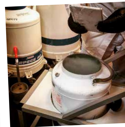
När labbet i USA omprogrammerat cellerna till CAR T-celler och skickar tillbaka dem till sjukhuset sker det i ett särskilt kvävetransportkärn som håller temperaturen under minus 150 grader.
